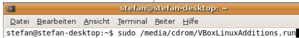
Abbildung 10: Über das Terminal sind die Gasterweiterungen schnell installiert
